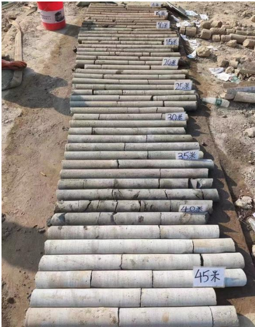
图 1.1 南沙至珠海(中山)城际(万顷沙-兴中段)盾构区间地基处理芯样照片
