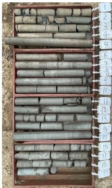
图 6.2 多层互剪搅拌桩 7d 龄期芯样照片
